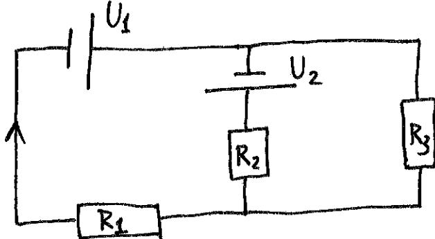
a) Når  $R_1$  er veldig stor vil kretsen reduseres til kretsen som består av batteriet med spenning  $U_2$  koblet i serie med motstand  $R_2$  og  $R_3$ . Ved Ohms lov er strømmen gjennom motstand  $R_3$  da gitt ved
