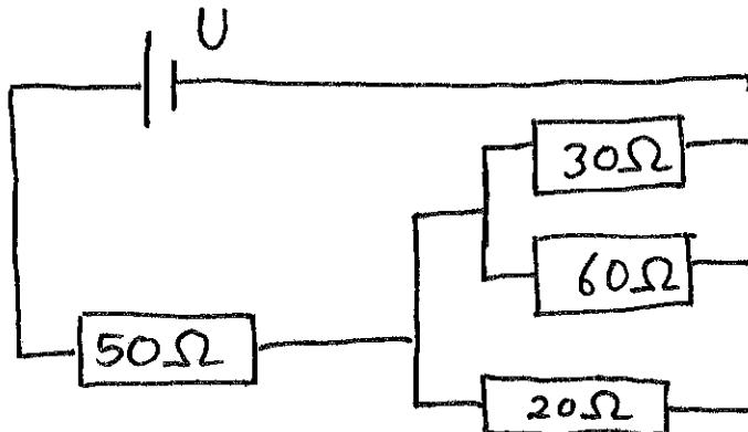
De tre motstandene som er koblet i parallell har en resultantmotstand  $R$  som er gitt ved
